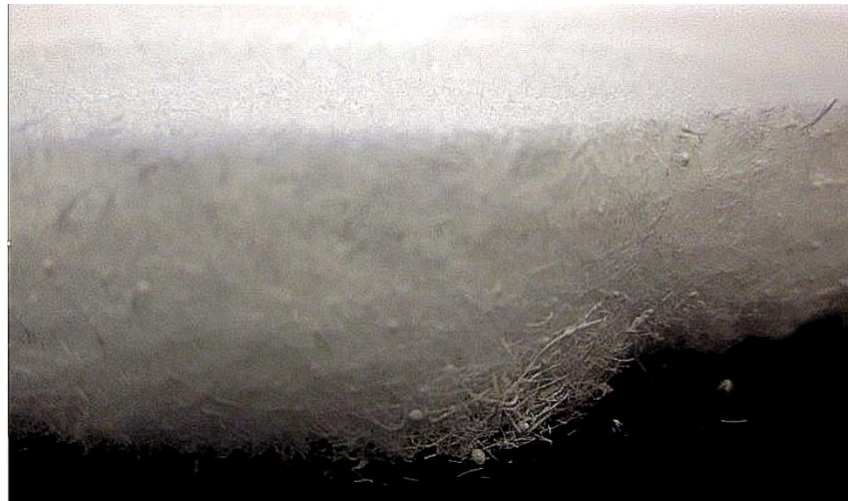
12. ábra. Centrifugális oldat spinninggel készült préselt szálpaplan fényképe.
